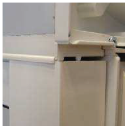
Die ALU-Führungsschiene so positionieren, dass der „Zahn“ in der Führungsschiene direkt an deren Seitenwand verdeckt bleibt
